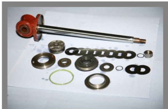
Ein Stoßdämpfer besteht aus vielen Einzelteilen.
