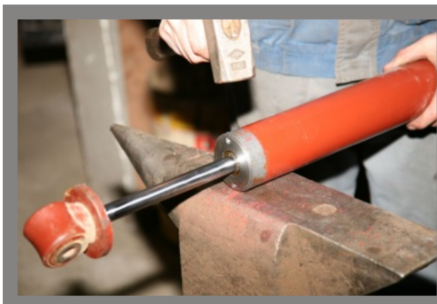
Mit leichten Hammerschlägen wird das festsitzende Gewinde gelöst.
